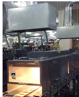
局所排気装置により熱と臭いを軽減(口糊加工機)
